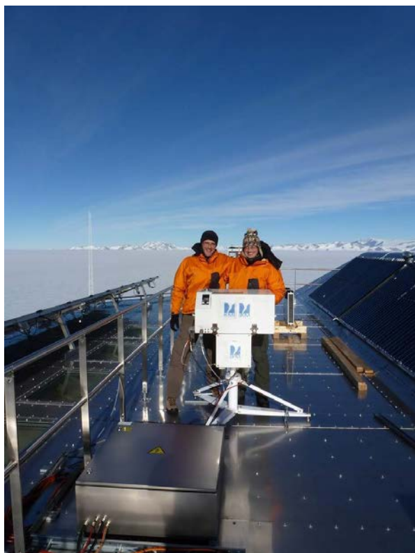
Figure 2: Les 2 scientifiques de l'IRM derrière le spectrophotomètre (à gauche) et l'indice UV effectif déduit du spectrophotomètre situé à la base du Pôle, le 26 novembre 2014 (à droite).
