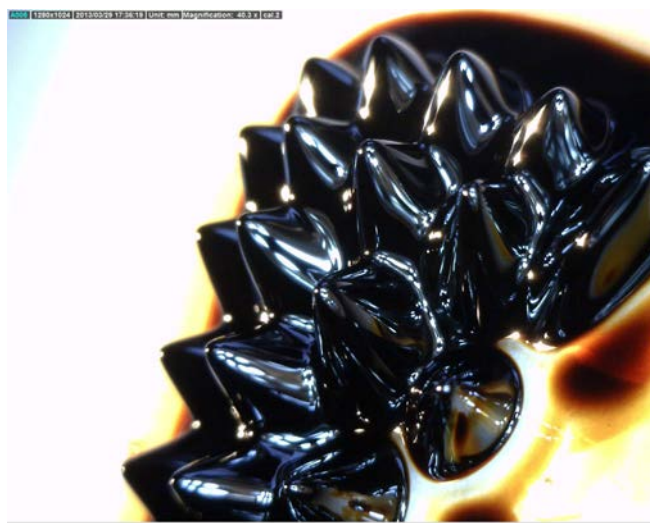
Figure 19: Photo d'un fluide contenant des particules nanométriques d'oxyde de fer (ferrofluide) sous l'influence permanente d'un aimant. Les pics, qui n'apparaissent que sous l'influence d'un champ magnétique, représentent les lignes de force générées par l'aimant.
